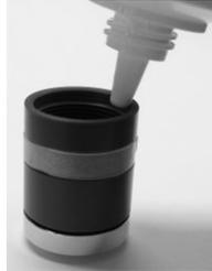
3. Den Schlauchring der Membrankappe, der die Ventilöffnung verschließt, seitlich abheben, so dass die Ventilöffnung frei liegt (siehe Bild unten).
