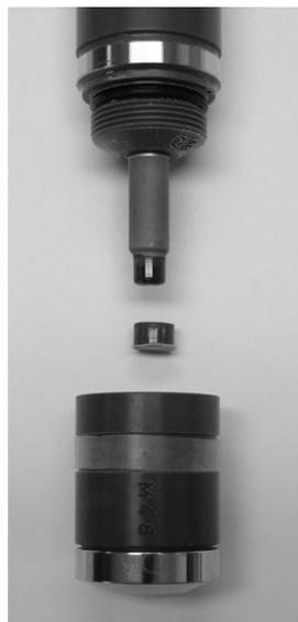
2. Die Spitze von der Tropfflasche abschneiden, bis die Öffnung in der Spitze sichtbar ist, und die Membrankappe bis zum Rand mit Elektrolytlösung blasenfrei füllen.
